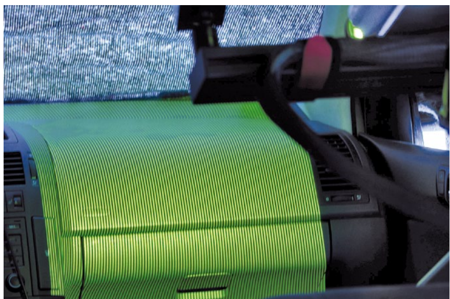
Das projizierte Streifenmuster dient der Erfassung der 3D-Oberfläche
