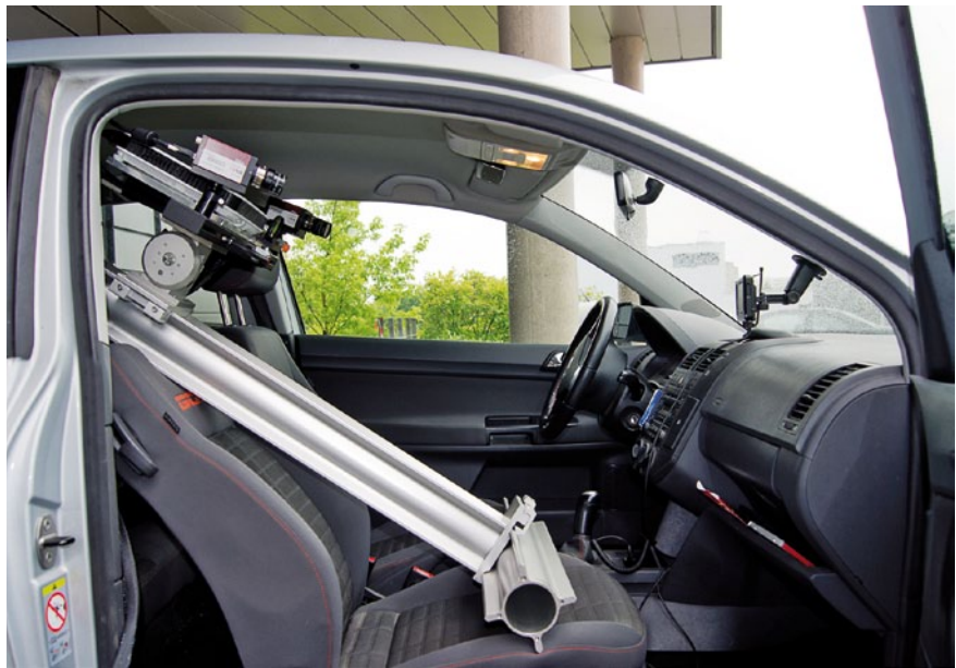
Das Surface-Control-System ist auf einer mobilen Halterung montiert und überprüft die Oberfläche der Instrumententafel
